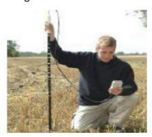
Die PR2 kann aber auch in Verbindung mit einem Datenlogger (z.B. dem eigens für solche Zwecke entwickelten DL6 Soil Moisture Logger) zur kontinuierlichen Messung eingesetzt werden.
