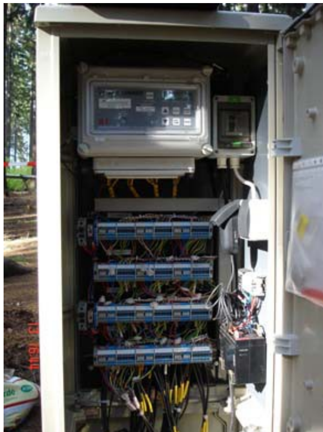
Abb: Delta-T Logger in Schaltschrank inkl. Vakuumanlage mit Solarstromversorgung bzw. in Gehsteigverteiler mit Netzanschluß.
