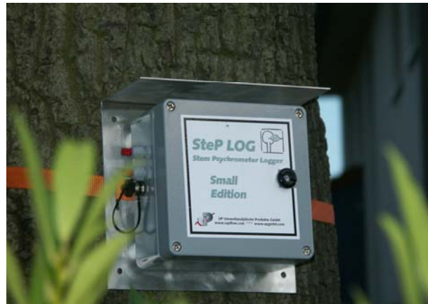
SteP-LOG mit Montagehilfe (Regenblech und Zurrurt)
