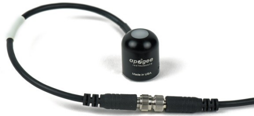
Inline-Kabelanschlüsse werden 30 cm vom Kopf entfernt installiert
