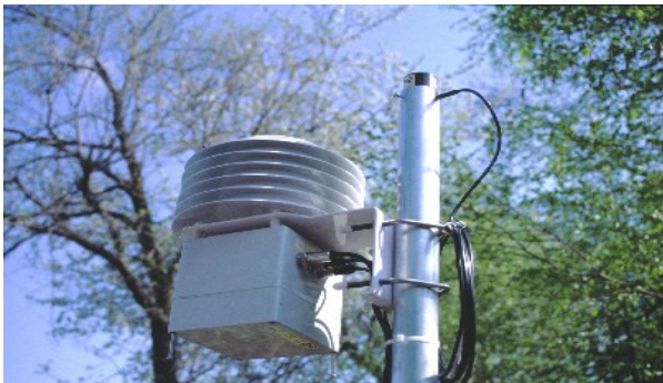
Das Bild oben zeigt einen Datahog2 mit integriertem Luftfeuchte-/temperatur-Fühler in einer Abschirmung, an einem mobilen Mast
