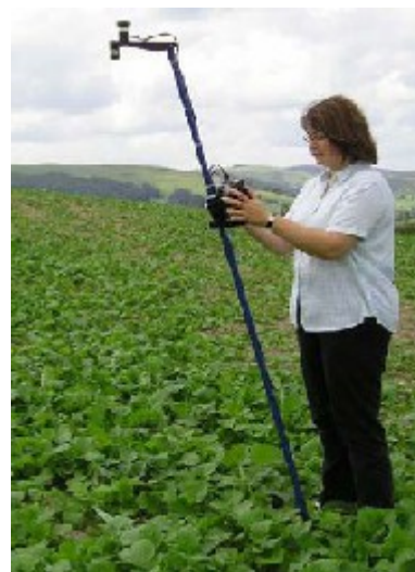
Abb2: SpectroSense2 bei NDVI-Messung
