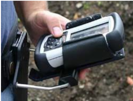
Abbildung 3: Robuster PDA mit dem Holster Gurttyp SS1-HB1
