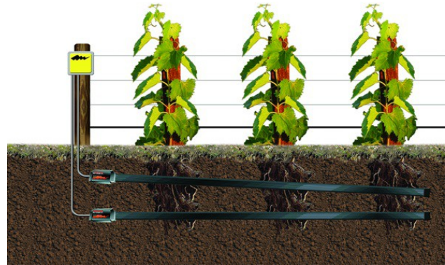
Beispiel für eine Installation: Mit dem oberen, schrägeingebauten Sensor, wird die Feuchte in der Wurzelzone gemessen. Der untere Sensor mißt, ob zu stark bewässert wird (Wasservergeudung!)
