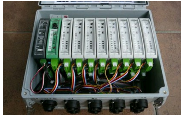
Beispielausführung: Box mit 8 Regeleinheiten und Datenlogger (bis 16 Regler/Logger möglich)
