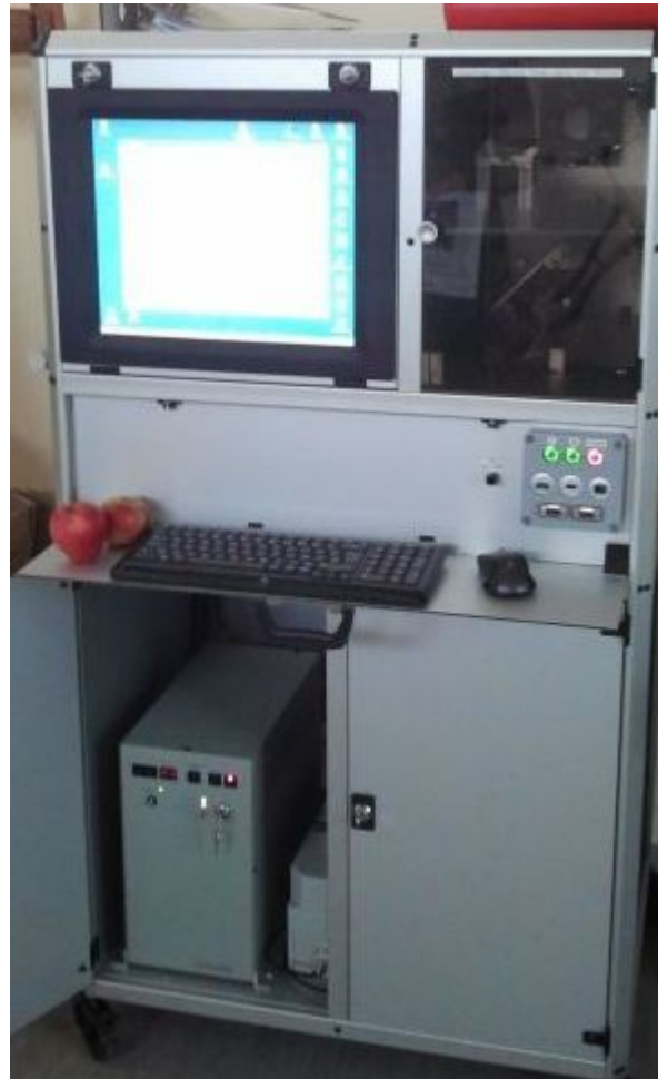
Abb1: Rechts Tür, Zugang zur Probenkammer, links Industrie-PC (dahinter Laser, IMS), unten Netzteil des Lasers.
