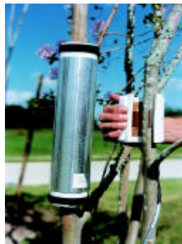
Dynagage-System für Gräser und geringe Stammdurchmesser
