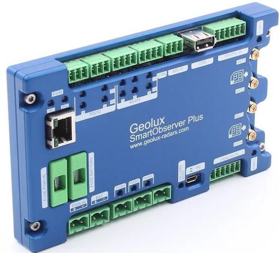
Der SmartObserverPlus verfügt über ein modulares Kommunikationssystem, das flexible Optionen wie GSM/GPRS, LoRaWAN IoT, und moderne Satellitenkommunikationsschnittstellen besitzt.
