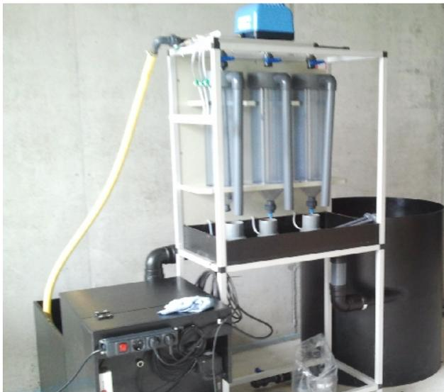
Abb1: 3-säulige Wurzelwaschanlage mit Wasserrückgewinnung
