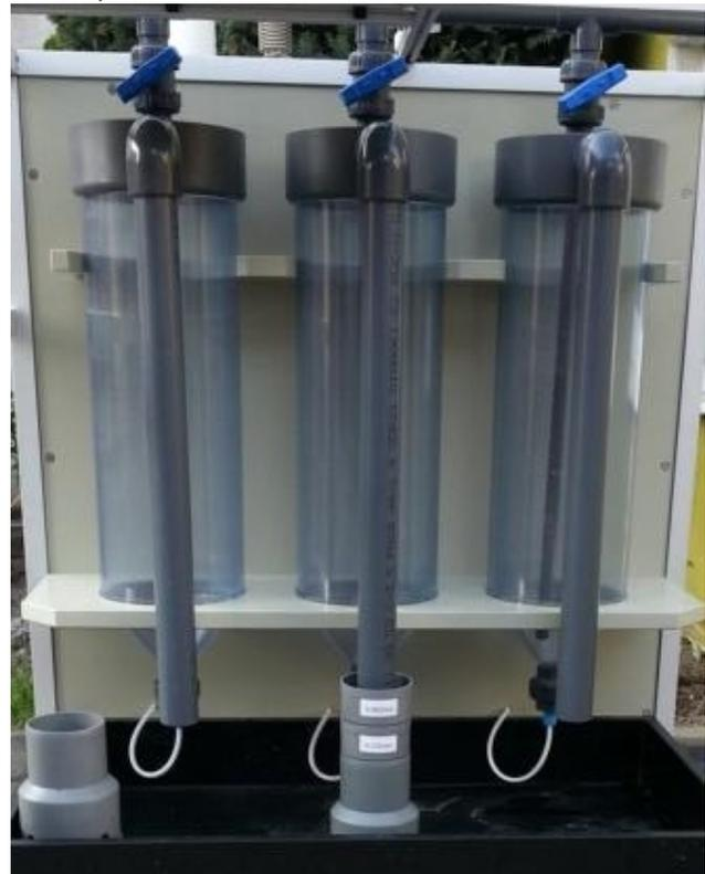
Abb2: Detail – Waschsäulen mit Wurzelauflösung
