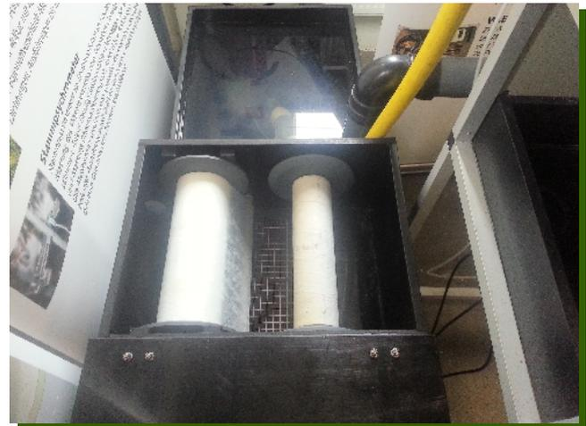
Partikel über ca. 40µm zurückgehalten. Dadurch setzt sich das Filtervlies langsam zu, was gleichzeitig die Filterfeinheit steigert und das Wasserniveau erhöht. Ist ein vordefinierter Maximalstand im Vliesfilter erreicht, wird die Vliesrolle automatisch ein kleines Stück weiter gedreht und somit neue Filterfläche zur Verfügung gestellt. Lediglich der Verbrauch der Vliesrolle muss regelmäßig kontrolliert werden, um diese
