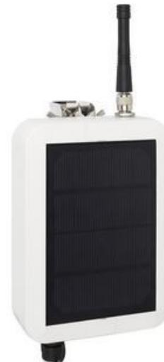
LoRaWAN-Modul mit Anschlußmöglichkeit für analoge Sensoren, SDI-12 und Niederschlags-sensor, Typ TBSL1 – [ArtNr. 02259a](#)
