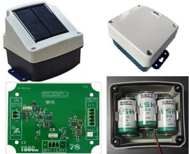
LoRaWAN-Modul mit integriertem Solarmodul, Typ TBS12S – [ArtNr. 02256](#)
