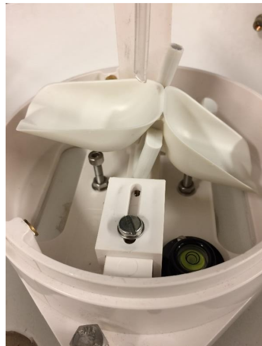
Abbildung 9 - Kalibrierung des Kalyx-RG
